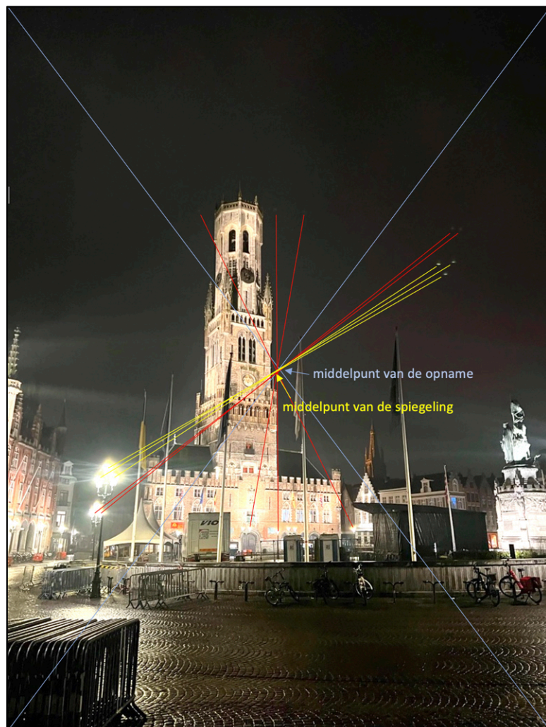
Geometrie van de verschillende lensreflecties.
